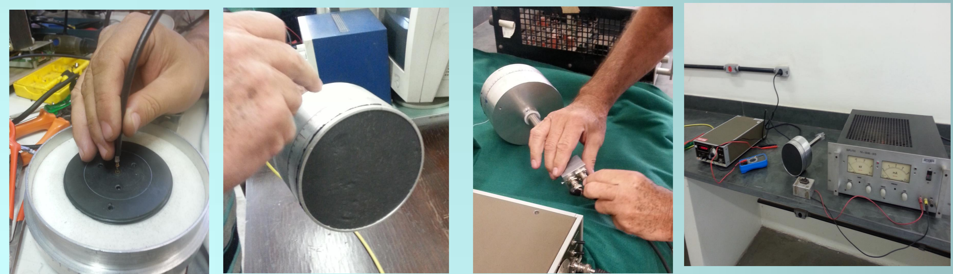
Figura 2 – Etapas de construção da câmara e eletrônica associada
