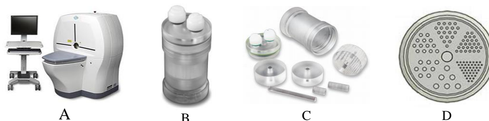
Fig. 1. (A) Tomógrafo GE LabPET SOLO 4; (B) Simulador montado; (C) Simulador desmontado; (D) Canais preenchíveis do simulador.
