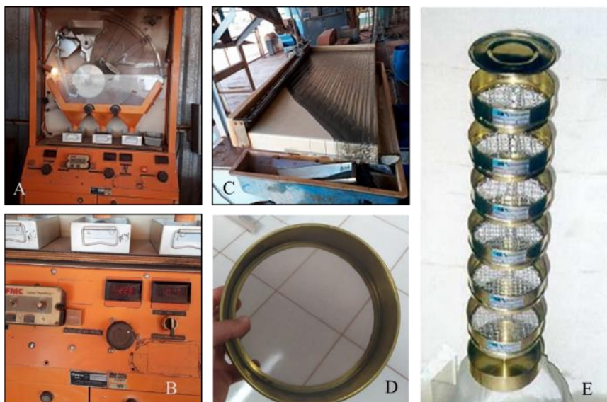
Fig. 11. Em A, Separador eletrostático utilizado. Em B, painel do separador magnético. Em C, mesa utilizada na separação gravimétrica. Em D e em E, peneiras usadas para a separação granulométrica.
