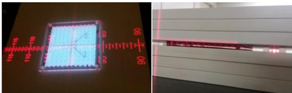
Fig. 1. Calibração dos detectores de LiF no feixe de 6 MeV.
