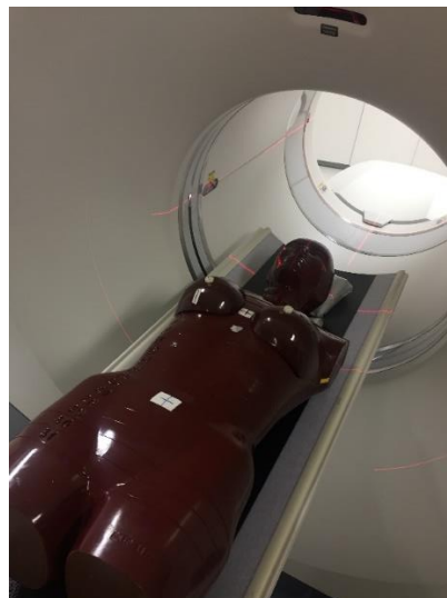
Fig. 1. Simulador antropomórfico Alderson Rando versão feminina posicionado no equipamento de PET-CT
