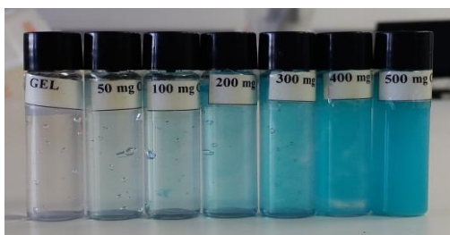
Fig. 1. Amostras separadas de 3 ml para irradiação do gel clínico e das amostras de mistura do gel com diferentes proporções de sulfato de cobre penta-hidratado.
