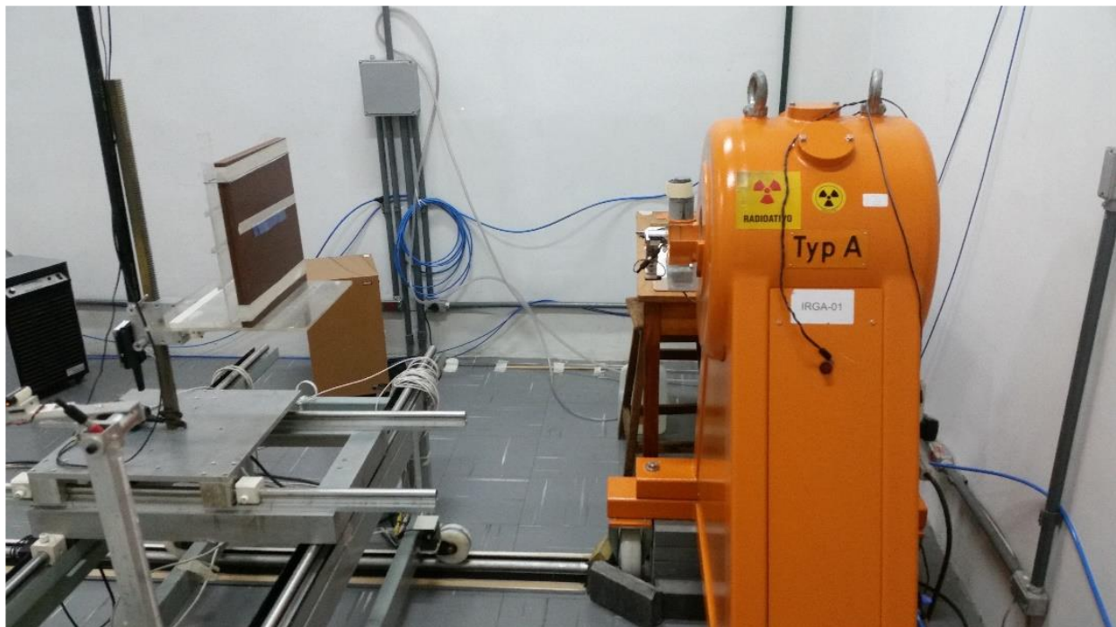
Fig 1. Instalação para irradiação com a fonte de céσιο-137.
