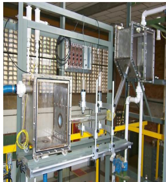
Fig. 2. Modelo de perna quente - circuito ar-água no CDTN
