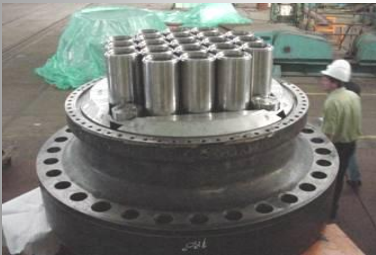
VASO DE PRESSÃO DO REATOR Peso: 29.200 kg
