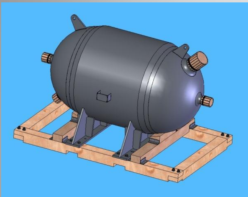
TANQUES DE COMPENSAÇÃO DO SISTEMA DE RESFRIAMENTO DE EMERGÊNCIA
