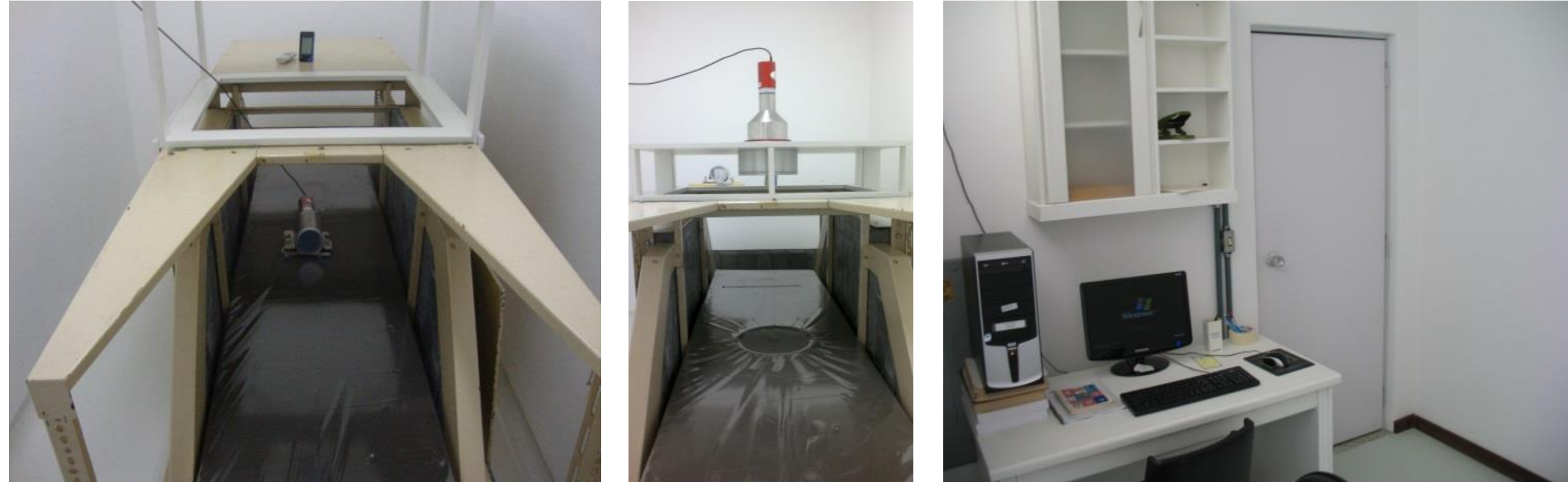
Figura 1: Detector NaI(Tl) 3"x3", o NaI(Tl) 8"x4" e a cama com blindagem tipo Shadow Shield e a sala de monitoração à direita com o Canberra Osprey MCA.
