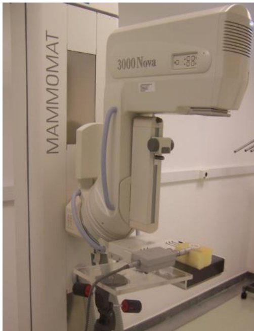
Sistema de calibração de dosímetros em feixes clínicos de mamografia.
