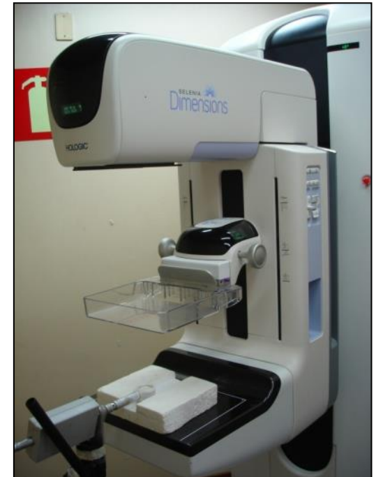
Sistema de calibração de dosímetros em feixes clínicos de mamografia.
