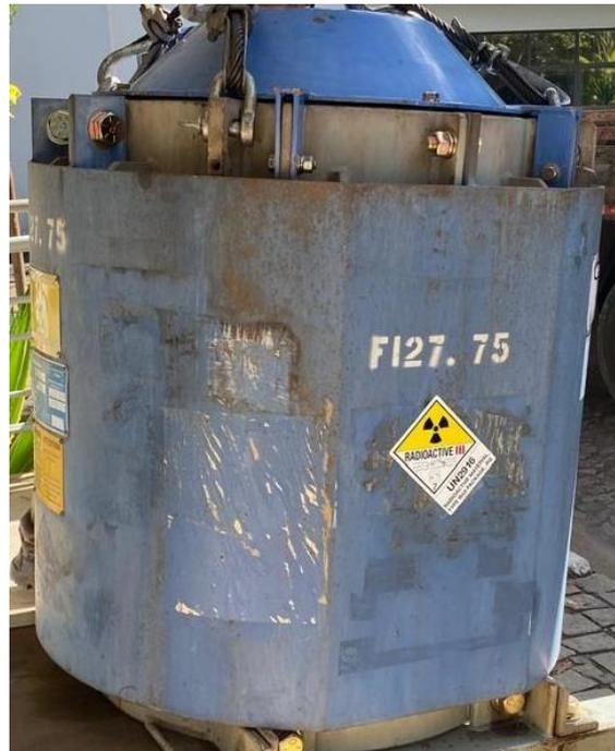
Fig. 2 – Fonte de Cobalto-60 instalada no LIG/CDTN.
