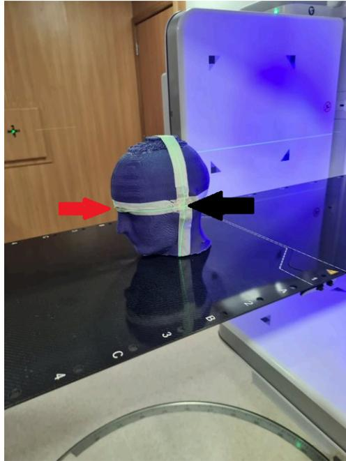
Figura 3. Parte externa do fantoma de crânio no qual foi fixado os dosímetros TL. Seta preta indicando posição dos dosímetros TL D1, D2, D6, D7, D8. Seta vermelha indicando posição do dosímetro TL E8. dosímetros TL D3, D4, D5 no lado oposto à seta preta.
