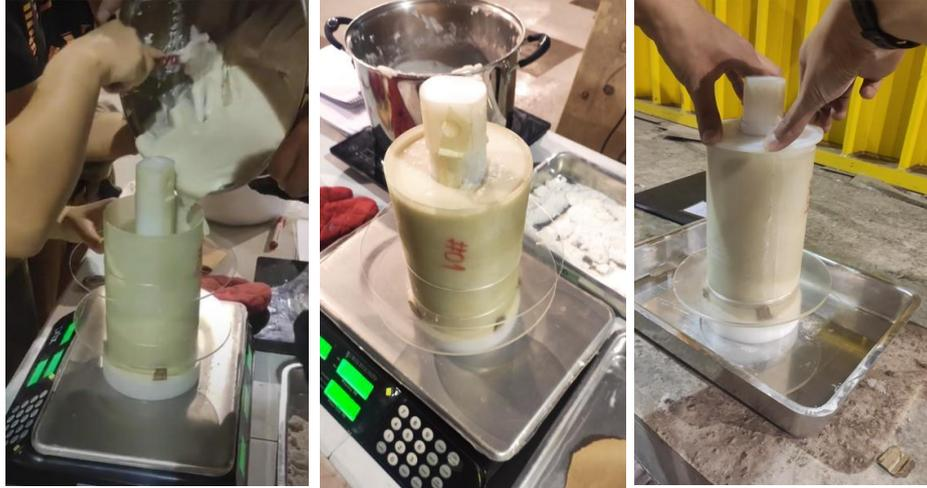
Figura 3.4: Processo de vertimento do propelente e início da moldagem.
