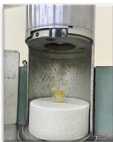
Fig. 1. Amostras no irradiador Co-60 - GamaCell 220.
