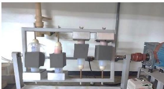
Fig. 2: agitador rotatório disponível no LABCIM.
