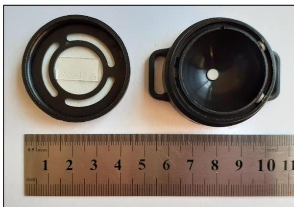
Fig. 2: Detector CR-39 e câmara de difusão.
